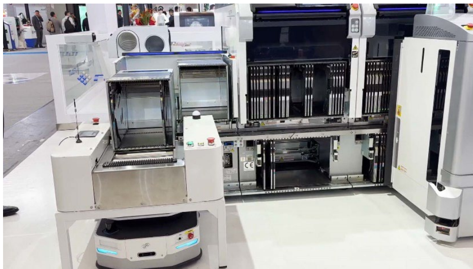
在 2025 年的慕尼黑上海电子生产设备展上，演示了斯坦德机器人的 AMR“Oasis-300E”将补料用供料器箱自动搬运到 FUJI 贴片机“NXTR A 机型”上
