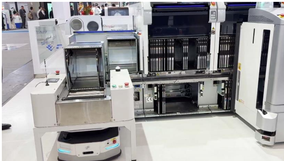
productronica China 2025 にて、Standard Robots の AMR 『Oasis-300E』が、 FUJI の実装機 NXTR A モデルに部品補給用マガジンを搬送
