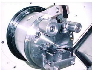
**特徴** レバー比を変更する事により、ロングストローク対応ができ、3爪でクランプできないワークにも対応できる。
