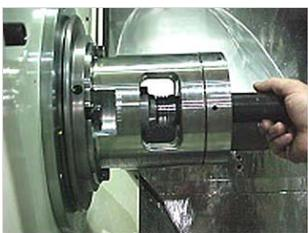
**特徴** ワーク基準がチャック前方にあり、チャック側面からワークを投入し内径を加工する。
