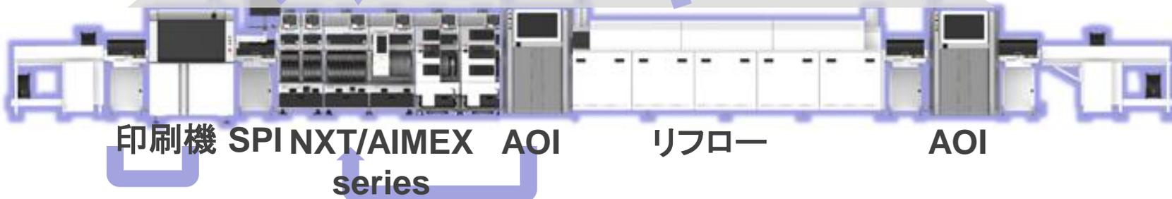
印刷機フィードバック制御
