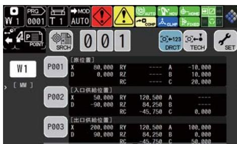
可直接输入机械手的动作点或直接登录当前的机械手坐标。
