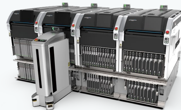
電子部品実装ロボット NXTR
